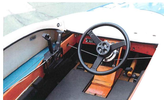
ボートは、ステアリングホイール(ハンドル)とスロットルレバーで操る。ステアリングホイールは、ワイヤーでモーターとつながっており、右手一本で回してモーター本体の方向を変えることでボートを左右に動かす。
